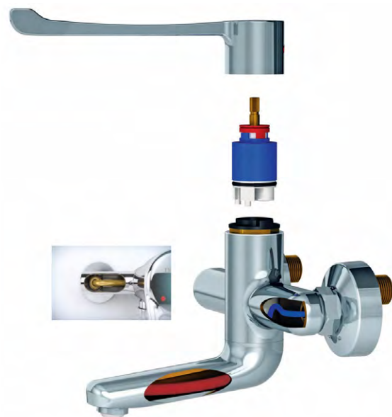
Rys. 15. Bateria o niskim poziomie wody w stanie stagnacji. Widoczna rurka prowadząca wodę do wylewki w korpusie baterii [1]
