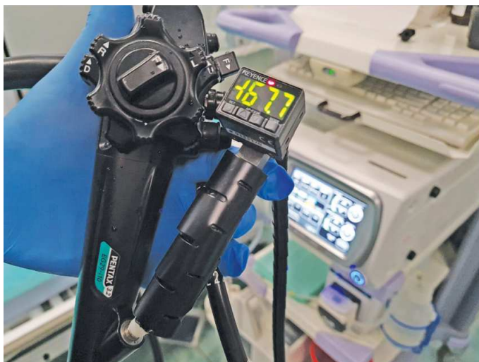
Rys. 2. Cyfrowy miernik ciśnienia dołączony do kanału roboczego endoskopu
