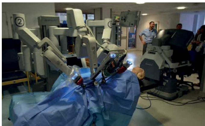
Rys. 7. Testy aparatury do wykonywania teleoperacji da Vinci na sali operacyjnej [26]
