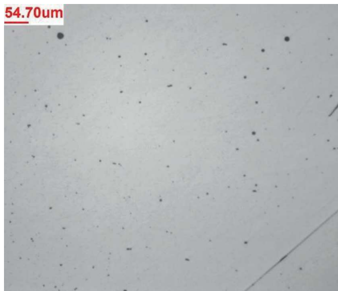
Rys. 7. Struktura materiału uszkodzonego imadła. Widoczne liczne pory, a także tlenkowe wtrącenia niemetaliczne. Stan nietrawiony
