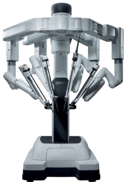
Rys. 6. Robot chirurgiczny da Vinci w układzie 4-ramiennym [25]
