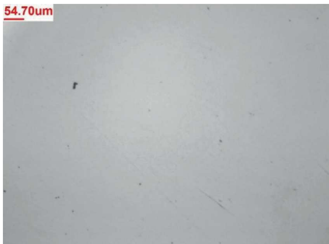
Rys. 9. Struktura materiału nożyczek. Widoczna jama skurczowa, pojedyncze tlenkowe wtrącenia niemetaliczne. Stan nietrawiony
