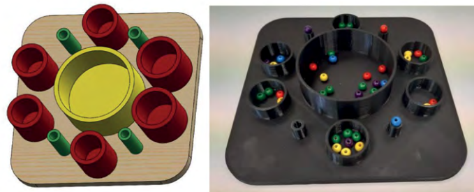
Rys. 3. Zestaw ćwiczeniowy do chwytania obłych kształtów: wizualizacja wykonana w programie SolidWorks2020 (z lewej), model fizyczny (z prawej)
